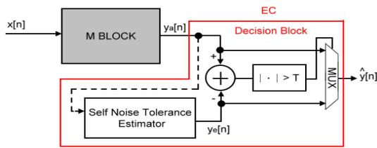
Fig. 3.1 Self Noise Tolerant Estimator
